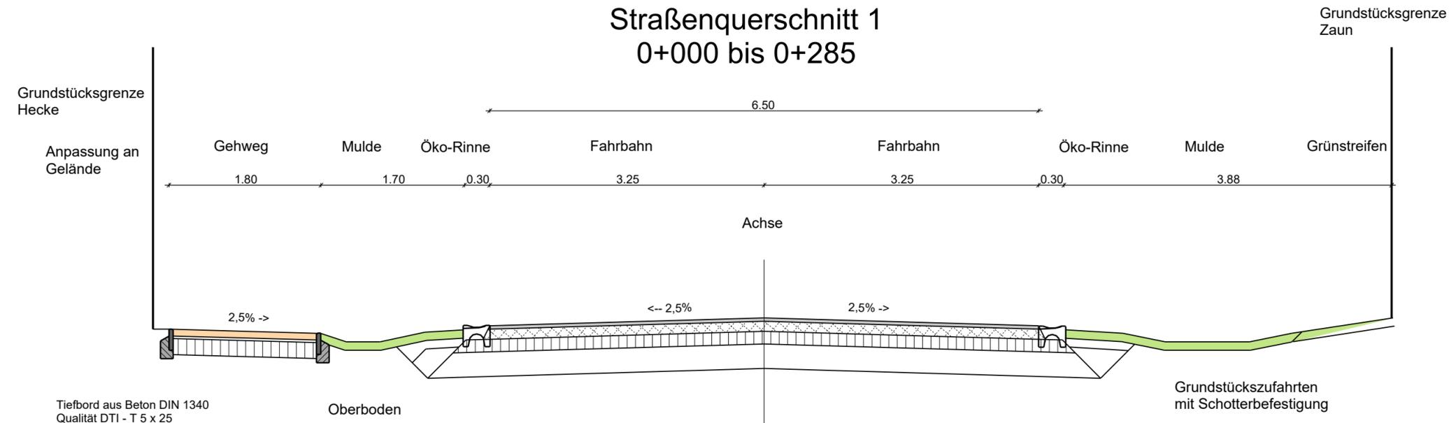
Tiefbord aus Beton DIN 1340
